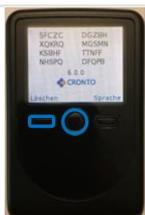
Das Gerät zuerst **ausschalten**. (kurze Zeit mittleren Knopf drücken)
