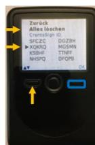
Mit der **linken Taste** **▲▼** zum gewünschten Vertrag oder „Alles löschen“ navigieren und anschliessend rechts mit **"OK"** bestätigen.
